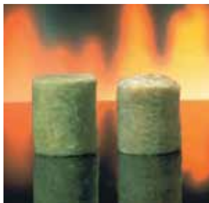
Слева образец каменной ваты до испытания на огнестойкость, справа - после испытания.
