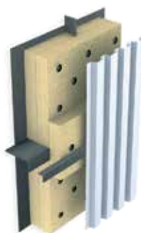
Стенка корпуса электрофильтра
