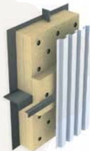
Стенка корпуса электрофилтра
